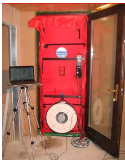
Комплект оборудования Blower Door. В состав комплекта входят специальные измерительные приборы, позволяющие определить разность давления внутри и снаружи здания, и калиброванный вентилятор, который устанавливают в проёме наружной двери.
